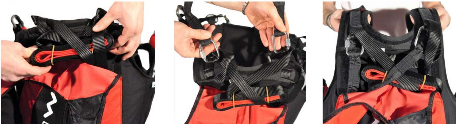
Für diese Verbindung benötigt man zwei Schraubkarabiner mit einer Bruchlast von mindestens 1400 kg. Es muss sichergestellt werden, dass die Länge der Verbindungsleine ausreicht, um das Rettungsgerät in den dafür vorgesehenen Rettungsgeräte-Container des Gurtzeugs einzufügen. Es muss genügend Leinenlänge vorhanden sein, um sicherzustellen, dass bei der Betätigung des Rettungsfallschirms der Rettungsschirm noch im Rettungsschirm-Container bleibt, bis er geworfen wird.
