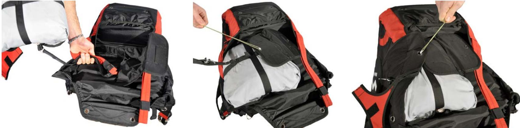
Führen Sie eine dünne Leine (Gleitschirmleine) in die Gummischlaufen, dann fädeln Sie die Ösen des Gurtzeug-Containers auf, beginnend mit den kleinsten, um diese unter Zug zusammenzuziehen. Folgen Sie dabei der Reihenfolge, die im Bild/Zeichnung ersichtlich ist.
