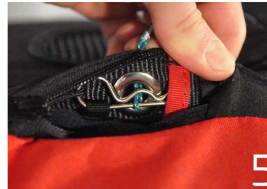
Befestigen Sie die soeben angebrachte Leine mit Klebeband an der Rauchbombe. Um im Flug die Rauchbombe vom Gurtzeug abzutrennen, ziehen Sie an dem roten Ball auf der linken Schultergurtseite.
